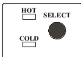
а) Кнопка SELECT (выбор) предназначена для выбора режима работы прибора: ламинирование холодным или горячим способом.
