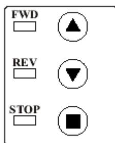
Кнопки FWD (вперед), REV (реверс) или STOP (остановка) предназначены для изменения режима работы прибора.
