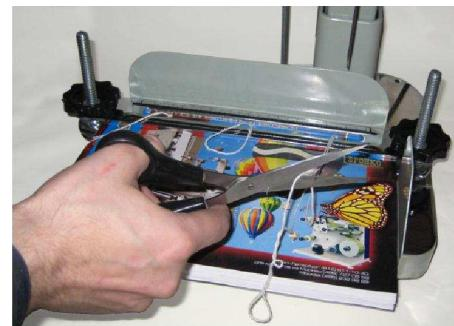
**12.** Снимите зажимное устройство со станка. Проденьте концы нити через ниточное кольцо или кольца средних отверстий, натяните завяжите узлом. Снимите материал с зажимного устройства. Переплет закончен.
