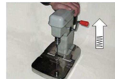
**3.** Образец нити установлен на станке. Если нет, установите нить как показано на рисунке и вытяните ее примерно на 25 см.
