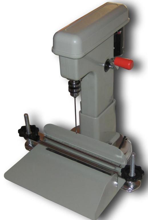
*Ниткошвейный переплётчик удобен в эксплуатации, компактен. Используется в книгопереплете, архивных, бухгалтерских или других документов требующих прошивки нитью. Данная модель специально разработана для небольших учреждений. Совмещает в себе сверлильный станок и швейную машинку, позволяет быстро прошивать нитью документ, не требуя усилий человека.*
