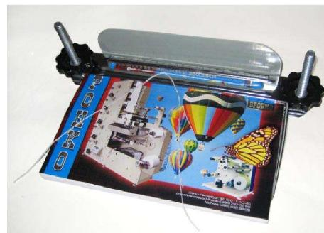
**13.** При необходимости сверления особо твердых материалов можно использовать сверло, имеющееся в комплекте. Для этого с помощью ключа снимите иглу и установите сверло. Таким же образом производится замена иглы
