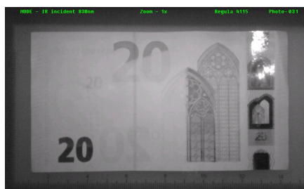
Сравнение исследуемой банкноты в инфракрасном верхнем свете (830 нм) с эталоном из базы данных валют
