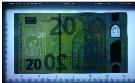
Сравнение исследуемой банкноты в белом донном свете с эталоном из базы данных валют
