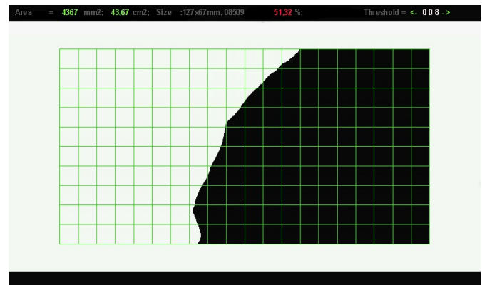
Автоматическое измерение площади (остаточной площади) банкноты
