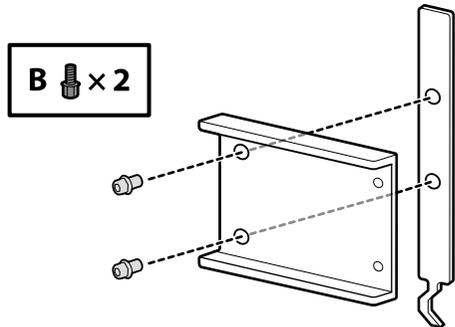
Należy obrócić o kilka obrotów śruby pokazane na rysunku, aby tymczasowo złączyć części. Elementów wymienionych w kolejnych punktach nie można ze sobą mocować, jeśli śruby są zbyt mocno dokręcone.
