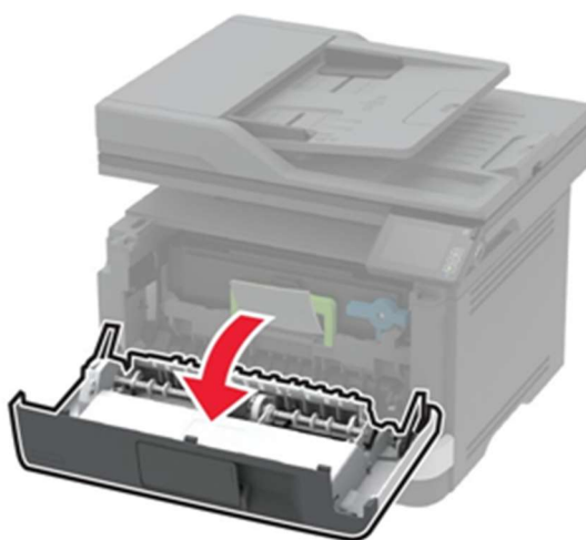
Рисунок 22 – Открытие передней дверцы.
