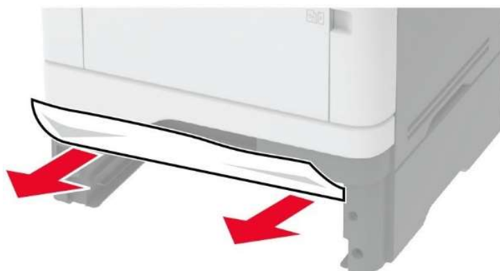
Рисунок 36 – Извлечение замятой бумаги.
