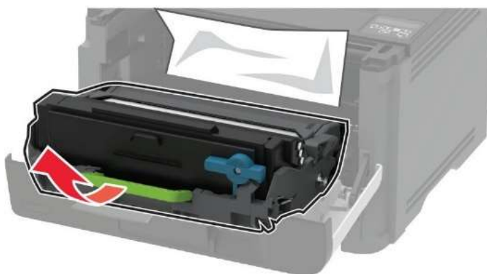
Рисунок 31 – Извлечение блока формирования изображения.
