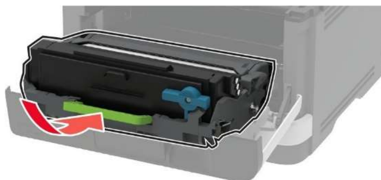
Рисунок 26 – Установка блока формирования изображения.
