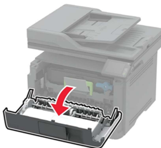
Рисунок 30 – Открытие передней крышки.
