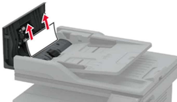
Рисунок 19 – Извлечение замятой бумаги.
