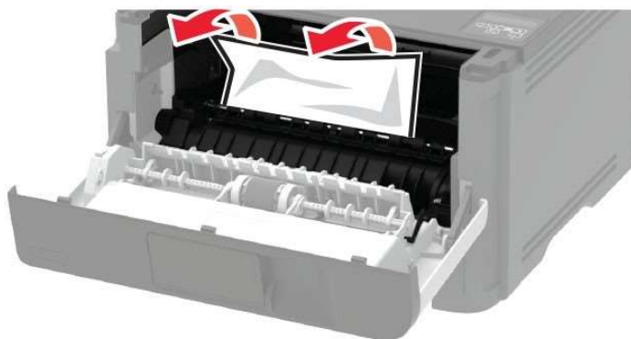
Рисунок 32 – Извлечение замятой бумаги
