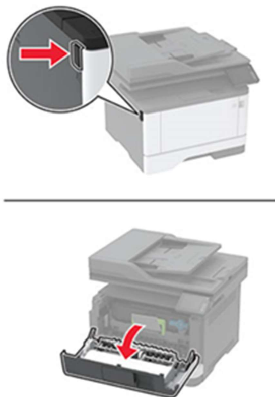
Рисунок 5 – Открытие передней крышки.
