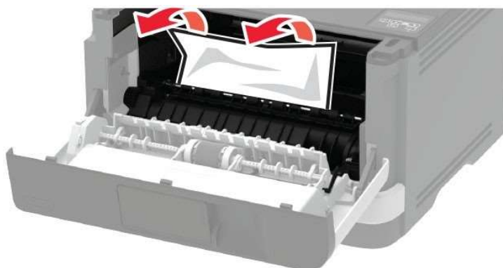
Рисунок 23 – Извлечение замятой бумаги из многоцелевого устройства подачи.
