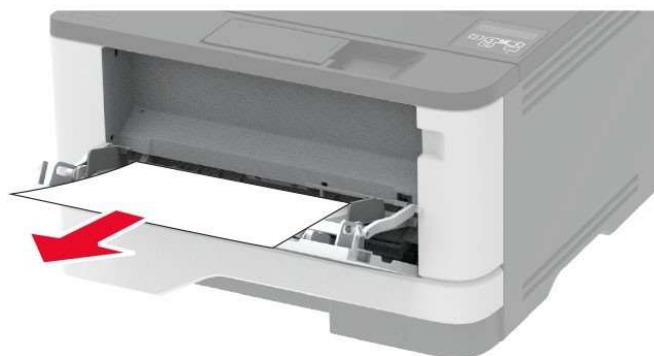
Рисунок 21 – Извлечение замятой бумаги из многоцелевого устройства подачи.
