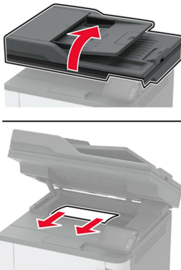
Рисунок 20 – Извлечение замятой бумаги в стандартном приемном лотке.
