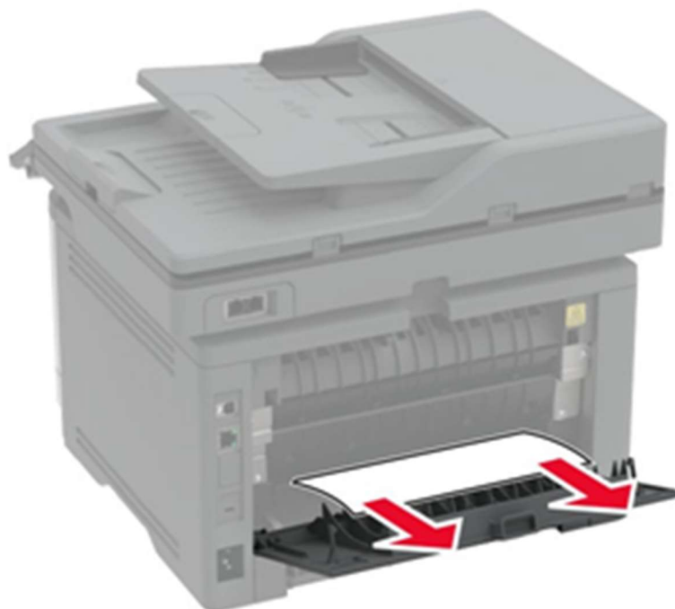
Рисунок 34 – Извлечение замятой бумаги.
