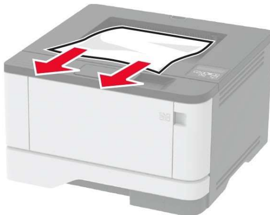
Рисунок 18 – Извлечение замятой бумаги в стандартном приемном лотке.
