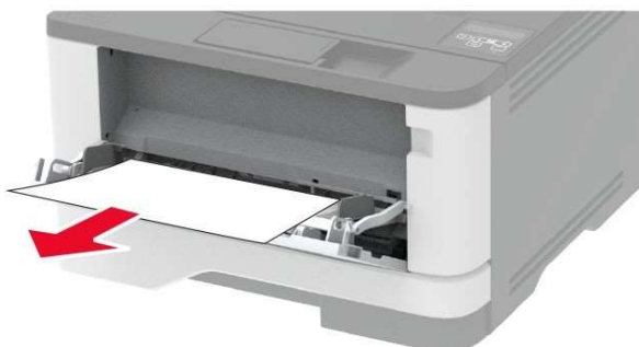
Рисунок 19 – Извлечение замятой бумаги из многоцелевого устройства подачи.
