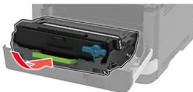
Рисунок 7 – Установка блока формирования изображения в принтер.
