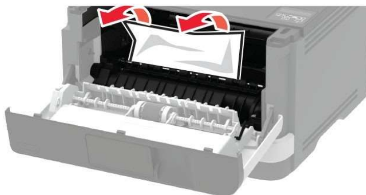
Рисунок 23 – Извлечение замятой бумаги из многоцелевого устройства подачи.
