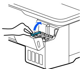
**4** Снимите транспортировочные крышки.
