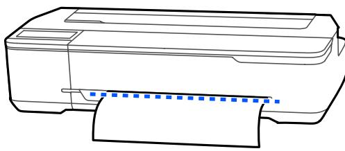
Линии отреза невозможно печатать дальше нижнего поля. После завершения перемещения бумаги нажмите кнопку (Отрезать). Отображается экран обрезки или выбора линии отреза.
