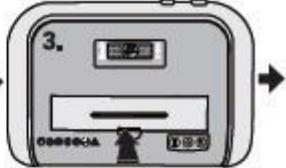
Откройте защитную крышку и зафиксируйте ее : внутри вы обнаружите проем для загрузки бумаги.
