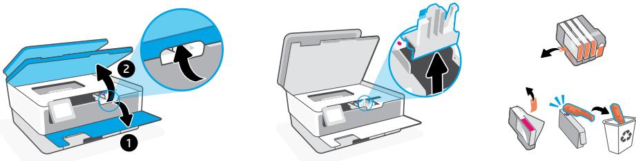
**SR** Otvorite prednja vratanca i podignite vrata za pristup kertridžu pored poklopca skenera. Uklonite plastični štitnik. Uklonite pakovanje kertridža, traku i narandžaste štitnike.
