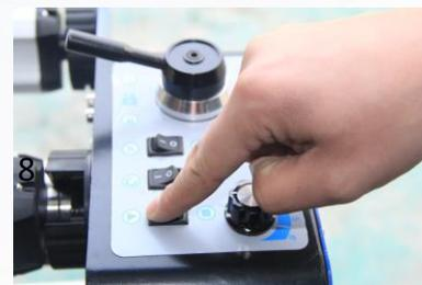
18. Включив переключатель Hot/Cold подогрейте рабочий вал. Нажав кнопку SET установите температуру нагрева (40-50°C для холодного ламинирования, 90-100°C для горячего ламинирования).
