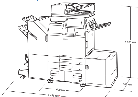
*1 648 мм при выдвинутом лотке финишера и выдвинутом справа выходящем лотке.
