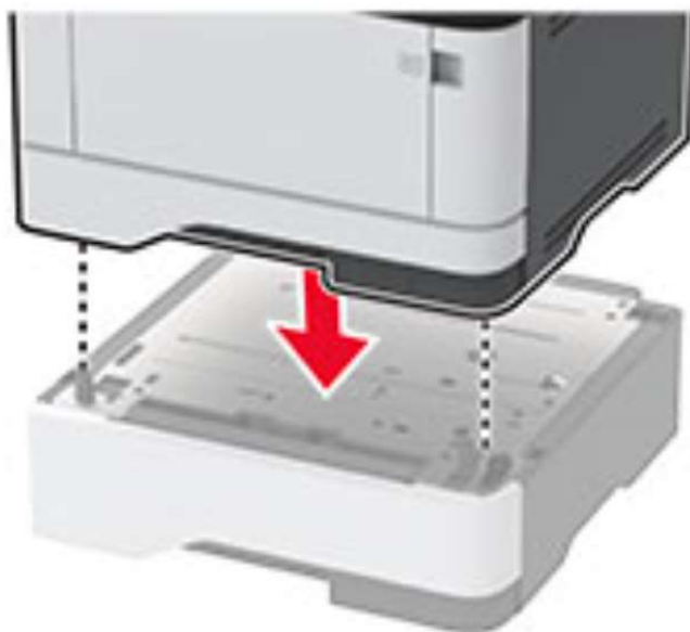
Рисунок 14 – Установка дополнительного лотка.
