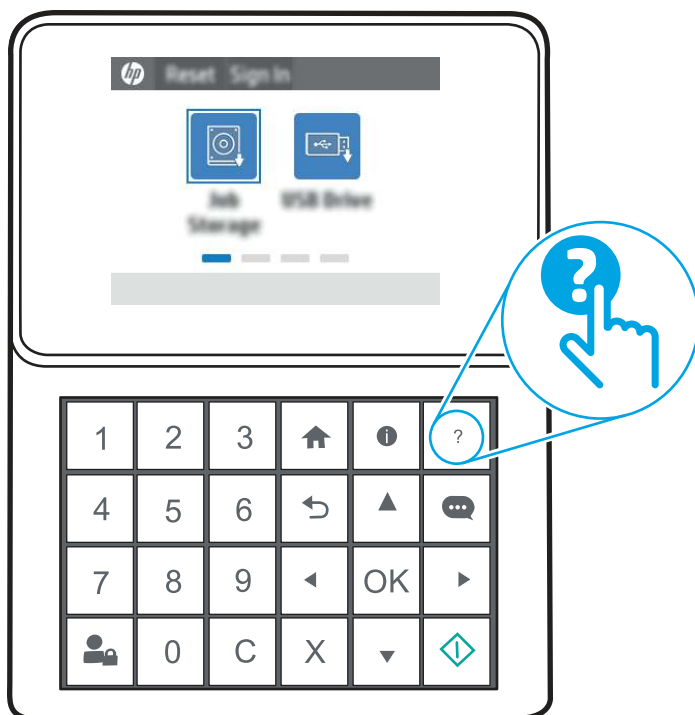
Рисунок 6-1 Кнопка «Справка» на панели управления
