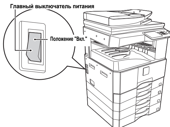
Главный выключатель питания
