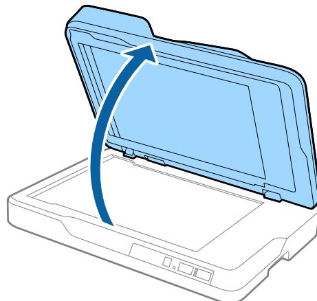
2. Поместите оригинал лицевой стороной на стекло сканера, чтобы верхний угол стороны, которую следует отсканировать, прилегал к углу сканера рядом с отметкой в виде стрелки.
