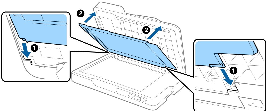
8. Закройте устройство автоматической подачи (ADF).
