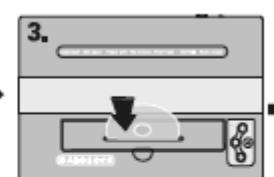
Вставьте пластиковую карту в проем загрузки. Аппарат включится автоматически и начнет работу.
