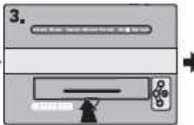
Откройте защитную крышку и зафиксируйте ее : внутри вы обнаружите проем для загрузки бумаги.
