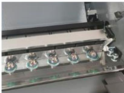
Отверстие для подачи бумаги оснащено роликовым механизмом, для более плавной подачи чертежных листов в главное устройство. Фальц вторым прогоном оснащен магнитным роликом. Чертежный лист после второго прогона становится более точным и прочным. Бумагоприемная платформа накладного типа делает сбор бумаги более удобным и быстрым.
